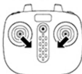
Schieben Sie den linken und rechten Joystick für 1 Sekunde lang in die unteren inneren Ecken. Die Blätter des Drohnes beginnen langsam zu drehen.
