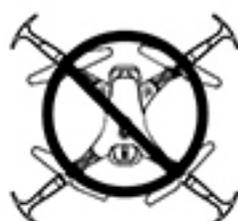
Wenn der Drohn direkt an einem Gegenstand gestoßen ist oder behindert wird oder sich die Propellerblätter nicht drehen, wechselt der Drohn sich in den Überstromschutzmodus.
