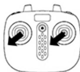
Wenn der Drohn im kopflösen Modus direkt an einem direkten Gegenstand gestoßen hat und eine Abweichung von der definierten Richtung auftritt, nachdem die Flugrichtung in die richtige Position gesetzt wird, sind der linke und der rechte Joystick gleichzeitig in die unteren linken Ecken gedrückt zu werden. Wenn sich die LED-Leuchtanzeige des Drohnes 3 Sekunden langsam blinkt und dann dauerhaft leuchtet, d.h. dass die Kalibrierung abgeschlossen ist.
