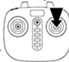
Drücken Sie kurz den rechten Joystick, um zwischen Hoch- und Niedriggeschwindigkeitsmodus zu wechseln.
